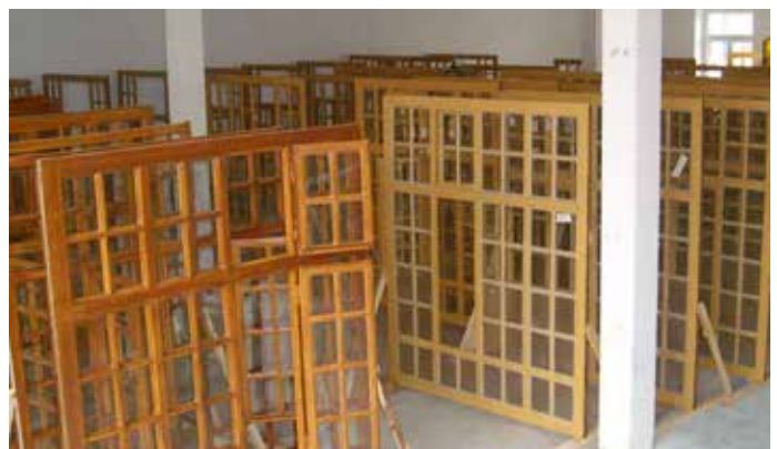
Beschichtung mit pigmentierter Leinölfarbe
